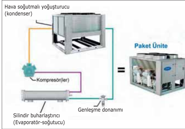
Şekil 1. Hava Soğutmalı Soğutucu Paketi
